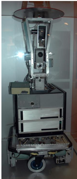
Immagine del robot "Shakey" sviluppato presso l'Università di Stanford alla fine degli anni 50
