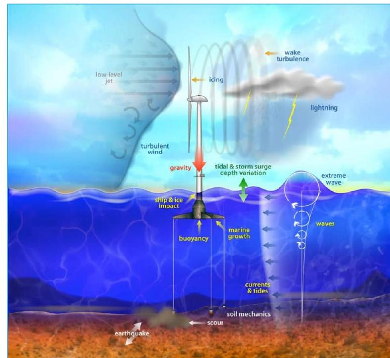
Ogni turbina è montata su una struttura galleggiante ancorata al fondale tramite sistemi di ormeggio non invasivi.
