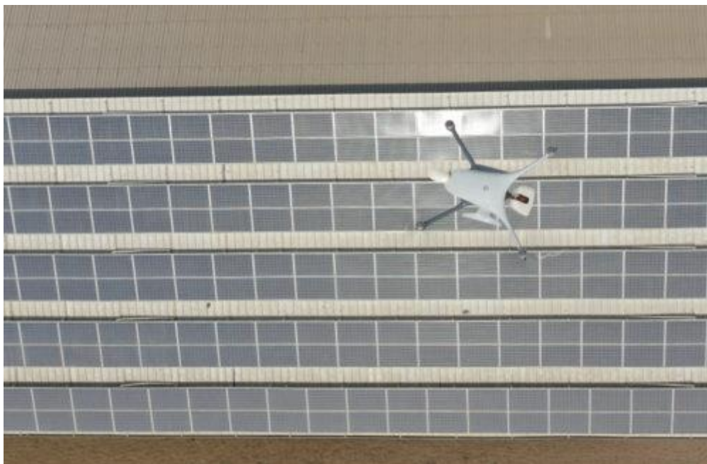
Figura 14 – Esempio di drone autonomo per l'ispezione di impianti fotovoltaici [14]
